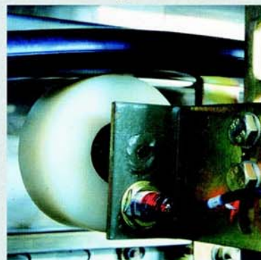
Controllo velocità corrimano. Handrail speed monitor.
