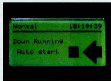
Autodiagnosi con display LCD. LCD fault display.
